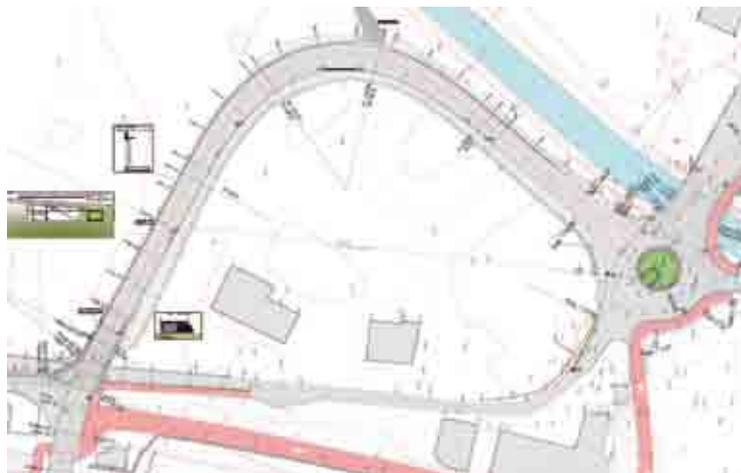
pleta ricostruzione di un nuovo manufatto più largo e con una "luce" di 16 metri. Inoltre è prevista la costruzione di una rotonda con raggio da 15,50 m quale collegamento con la strada comunale, la ciclabile e la strada per il depuratore.
